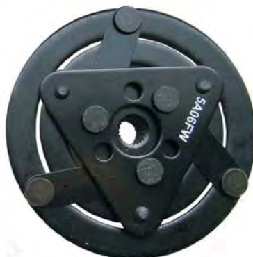
Přítlačný talíř typ C. Bez vývažku a s "tisícíhranem."
